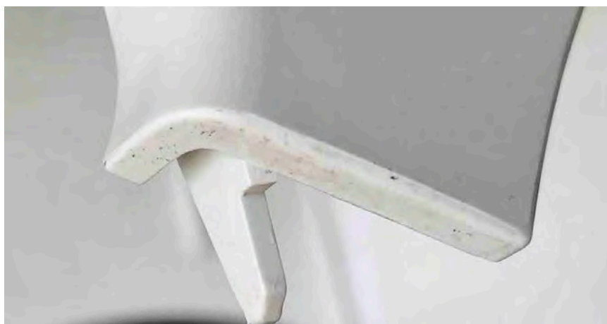
Antes de la limpieza: Pieza contaminada por residuos en el molde.
