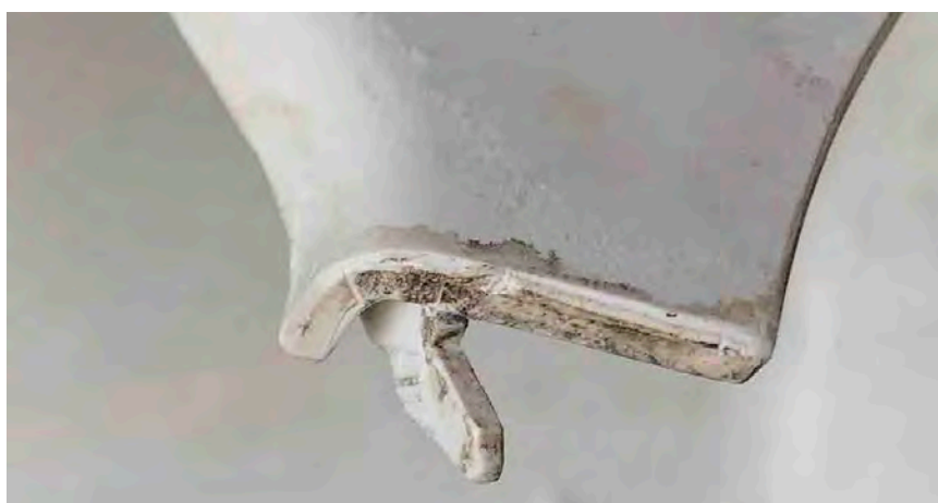
Durante la limpieza: Pieza muy contaminada que extrajo los residuos acumulados en el molde
