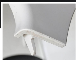
ANTES DE LA LIMPIEZA: contaminación de la pieza causada por residuos en el molde
