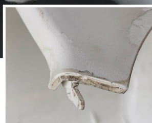
DURANTE LA LIMPIEZA: pieza muy contaminada extraída del molde tras la aplicación de Lusin® MC1718
